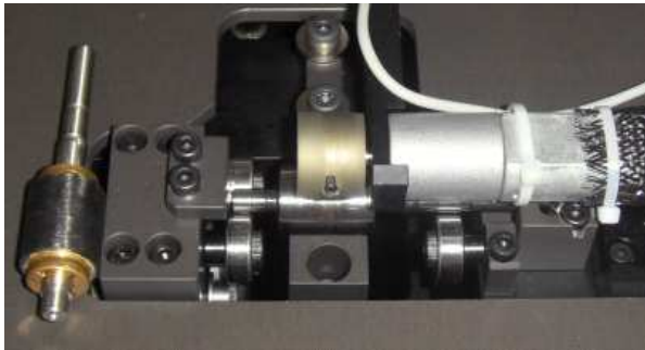
외경기준 Runout 측정
