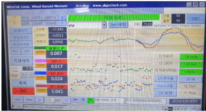
Compressor Wheel 내외경동심도 Runout
