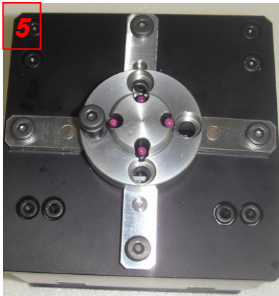
GuideUnit과 SlideNut가 완전히 밀착되도록 맞춤핀에 주의하여 조립한 후 내측 핀볼트를 조립한다.
