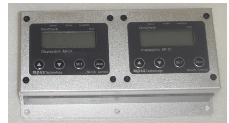
전Page의 방법으로 DisplayUnit Init(마스터값) 설정치를 변경한다. (동영상참조) 변경된 마스터로 마스터세팅한다
