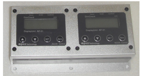
전Page의 방법으로 DisplayUnit Init(마스터값) 설정치를 변경한다. 변경된 마스터로 마스터세팅한다
